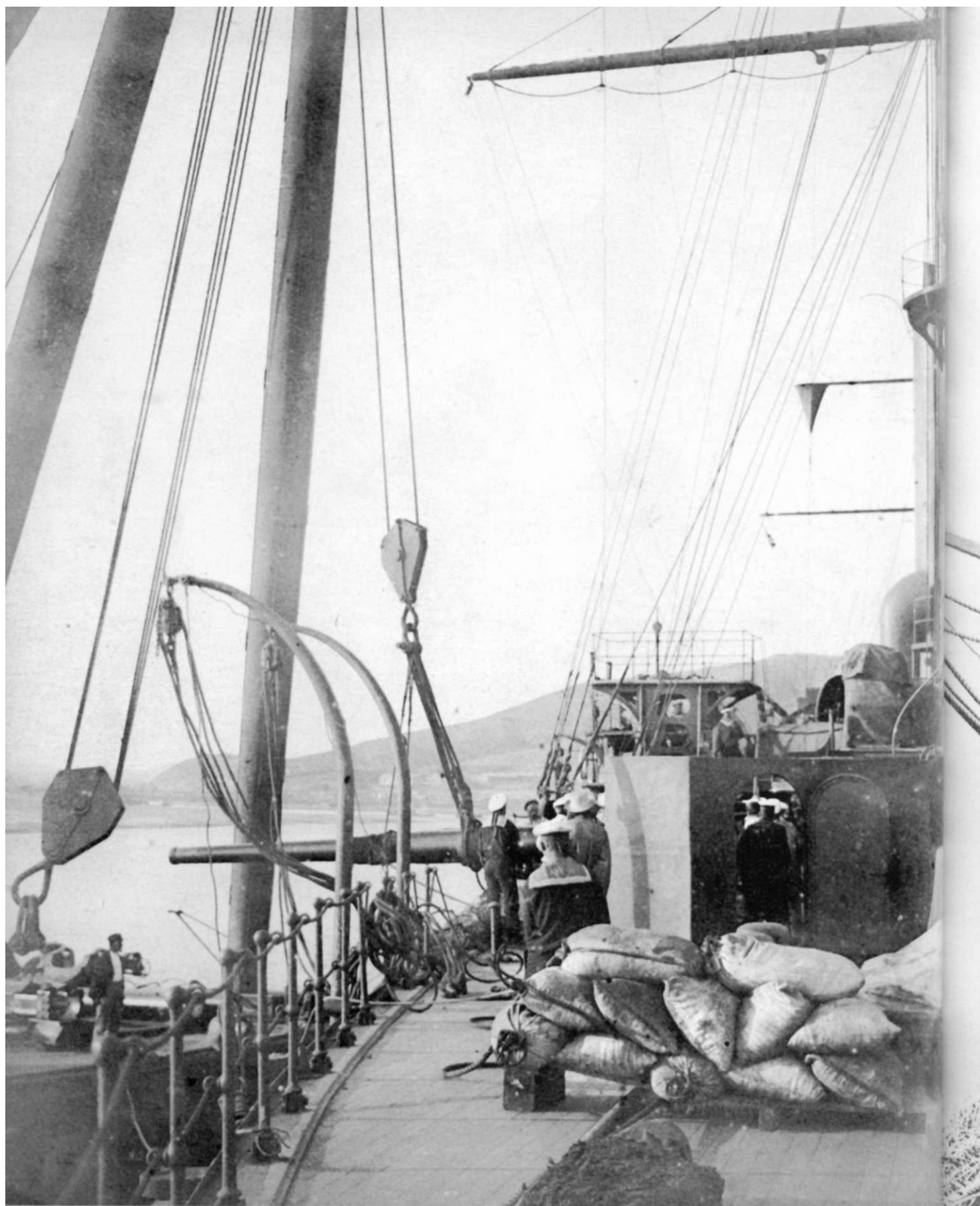
Крейсер «Паллада» в Порт-Артуре. Демонтаж 152-мм орудия с помощью плавучего крана, 1904 г.
